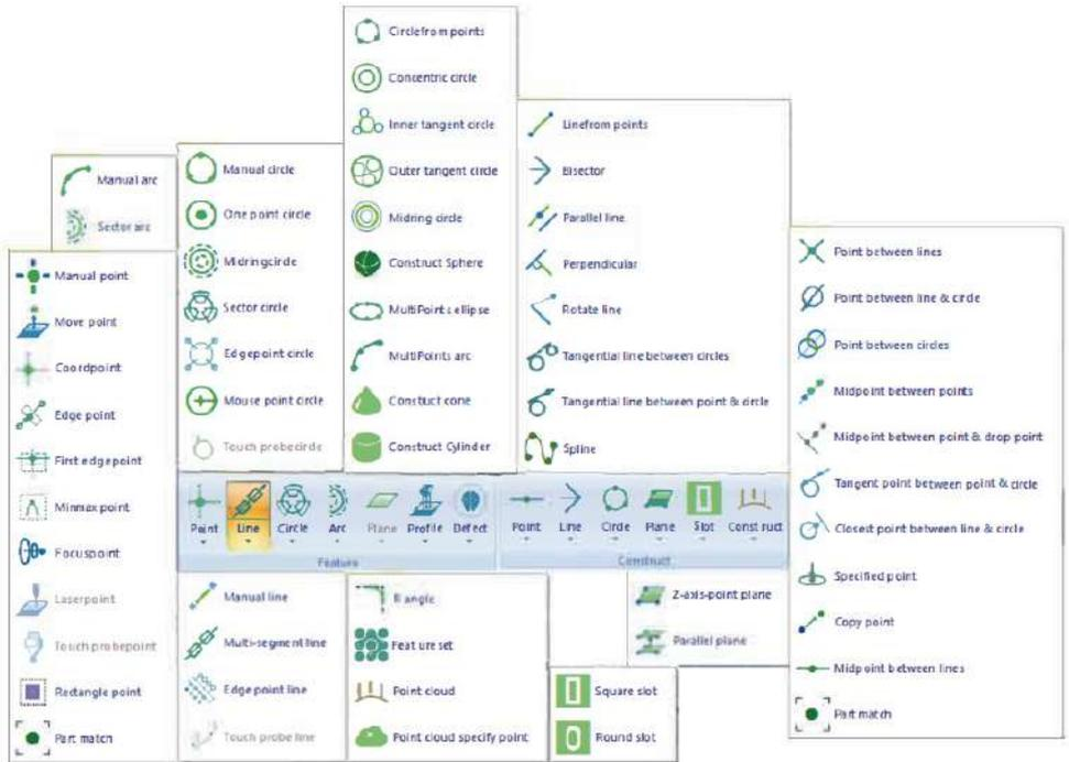
提供多种特征检测和构造工具,可自动提取零件几何形状。
