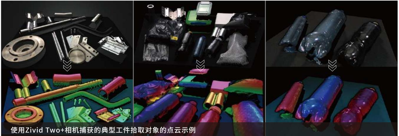
使用Zivid Two+相机捕获的典型工件拾取对象的点云示例
