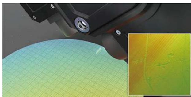
晶圆检测 (尺寸标注、分类、缺陷检测)
