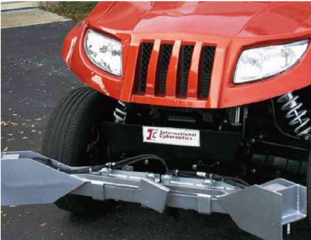
搭载Gocator的ICC公司MDR408x系列路面分析仪,用于评估路面质量指数(国际粗糙度指数IRI,表面光洁指数PI,驾驶指数RN,表面平滑度),车辙,纹理和裂缝。在Gocator的帮助下,MDR408x系列可在高速行驶下进行高精度路面检测,并且不受气温变化、阳光、风、路面颜色和纹理的影响。
